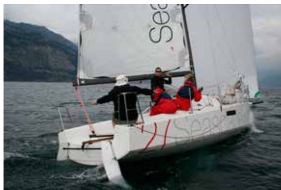
Overzichtelijke, eenvoudige roerinstallatie op de Seascape, met de helmstok onder de overloop door.
